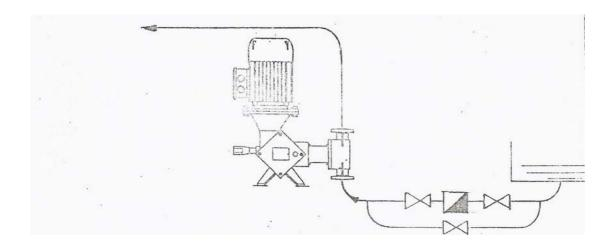
Quando si dosano sospensioni, il sistema delle tubazioni deve essere studiato in modo da evitare concentrazioni di sedimentazione, specie in prossimità della pompa. Pertanto evitare tratti verticali in mandata e prevedere il lavaggio della pompa e delle tubazioni subito dopo ogni arresto.
