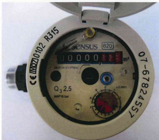
620C Q 3 2,5 mit Kunststoff, gekapseltes Zählwerk (Drauf- und Seitenansicht)
